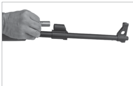
Sl. 12 Odvajanje regulatora barutnih gasova
