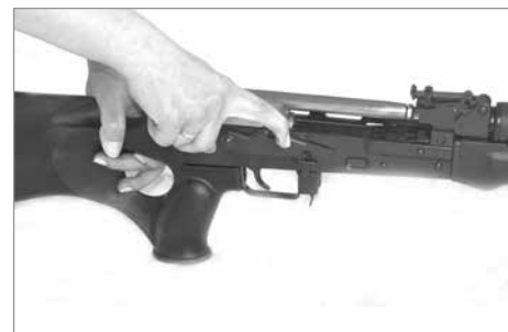
Sl. 9 Vađenje nosača zatvarača sa klipom
