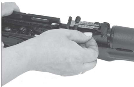
Sl. 11 Odvajanje gasnog cilindra
