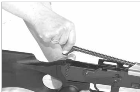
Sl. 8 Odvajanje povratnog mehanizma
