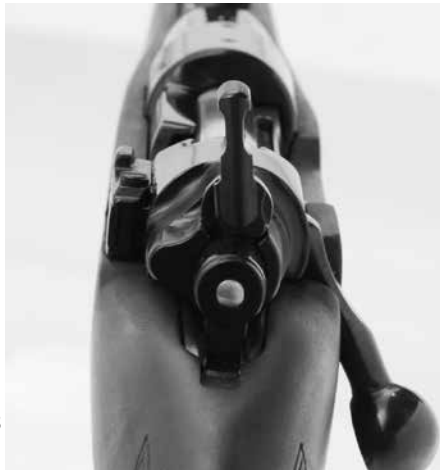
Sl. 13> Položaj leptir kočnice pri rasklapanju modela M98
