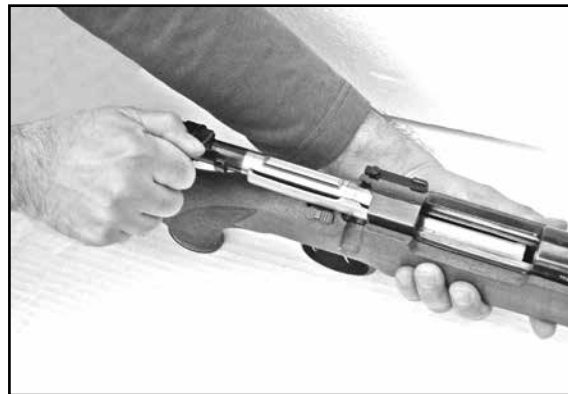
Sl. 8> Zatvarač u zadnjem položaju
