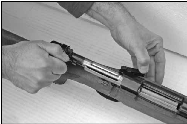
Sl. 14> Odvajanje sklopa zatvarača od karabina
