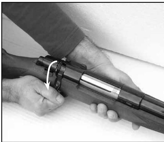
Sl. 10> Zatvarač u završnom položaju
